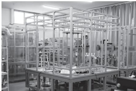
組み立て中のリチウムイオン電池製造設備
